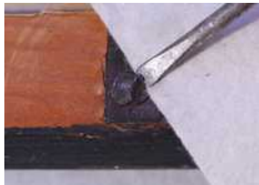
Abb. 208 Ausrahmen: Entfernung der Federbleche
