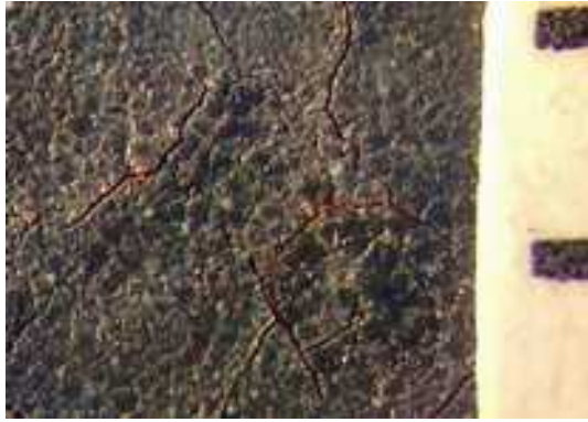
Abb. 138 Mikroskopaufnahme der Malschicht in einem stark ausgemagerten Bereich
