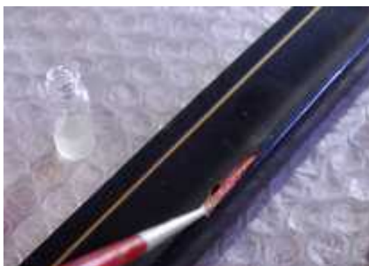
Abb. 200 Einbringen des Klebemittels in die Fehlstelle
