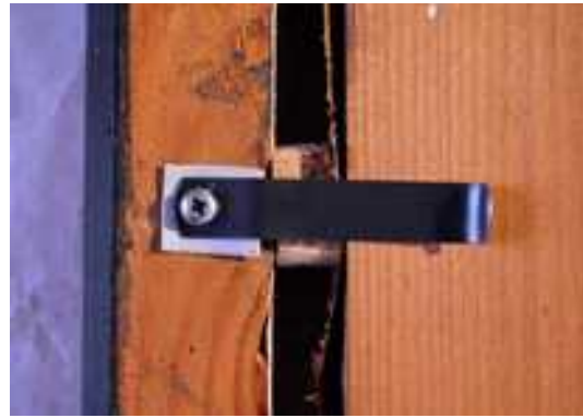
Abb. 214 Einrahmung mit Rahmenfedern, Abstandhalter aus Kork
