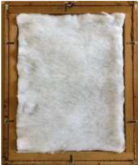
Abb. 174 Polyestervlies als Schwingschutz
