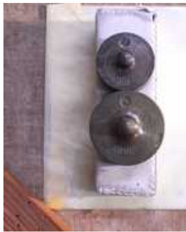
Abb. 192 Beschwerung während der Aushärtung
