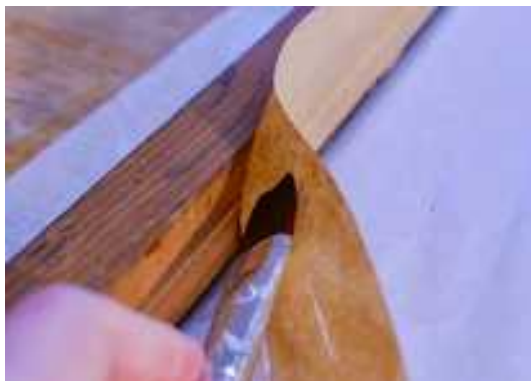
Abb. 211 Anfeuchten der Börtelstreifen
