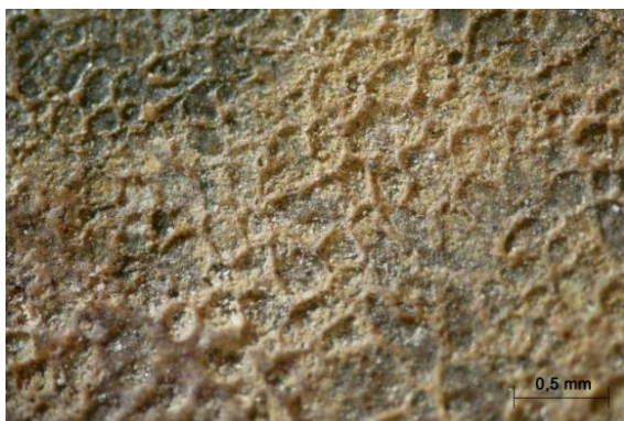
Braune Emailfarbe mit netzförmiger Oberfläche, Streiflicht, Innenseite, SM-Aufnahme
