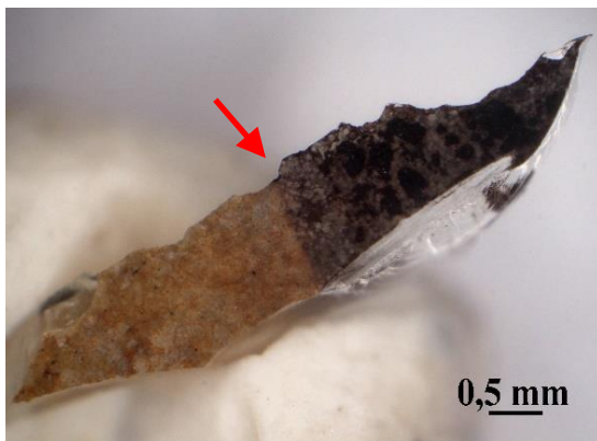
Probe HKV 22 vor dem Einbetten, Oberfläche mit weißer und darunterliegender brauner und schwarzer Emailfarbe, Innenseite, in Pfeilrichtung angeschliffen
