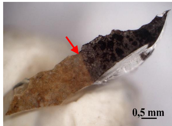
Probe HKV 22 vor dem Einbetten, Oberfläche mit weißer und darunterliegender brauner und schwarzer Emailfarbe, Fensterinnenseite, in Pfeilrichtung angeschliffen
