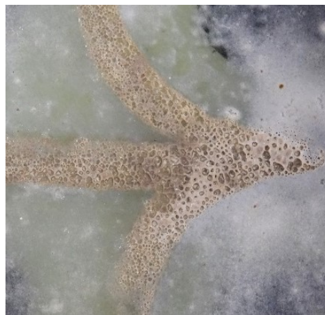
Abb. 73: braune Emailfarbe mit starker Blasenbildung unter weißer Emailfarbe, Detail aus Bleifeld 1d
