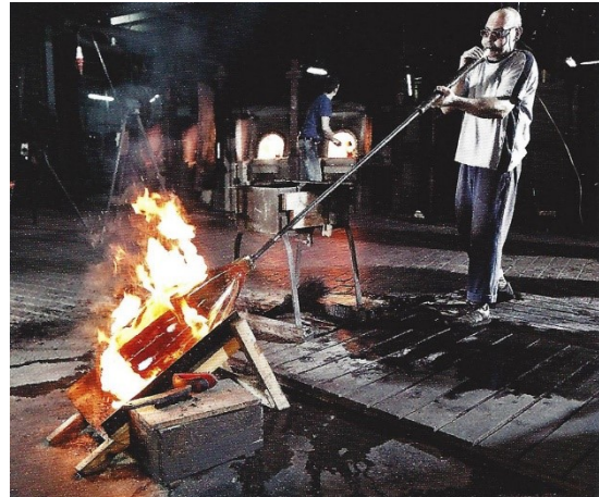
Abb. 57: Glasmacher beim Blasen eines Glaszylinders
