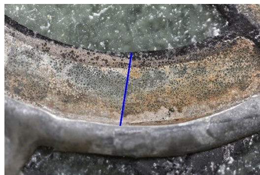
Abb. 147: Emailfarbe vor der Festigung (links) und nach der Festigung (rechts), Auflicht
