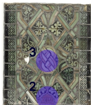
Abb. 72: Mit dem Kontaminationsmonitor und Ortsdosimeter detektierter Bereich 2 und 3 (blau markiert), Bleifeld 1d
