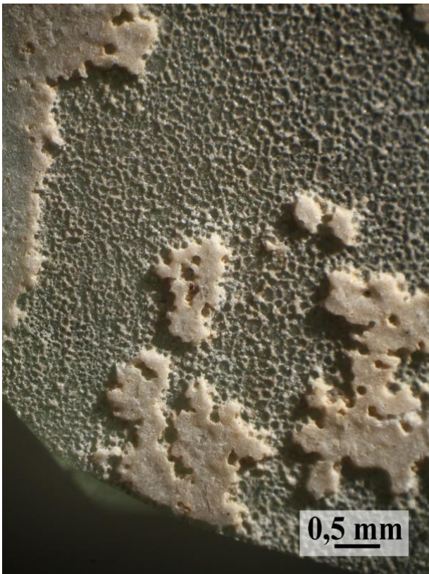
Großflächige Verluste der braunen Emailfarbe und erhaltene Inseln aus brauner und weißer Emailfarbe, Streiflicht, HKV 1, Außenseite, SM-Aufnahme
