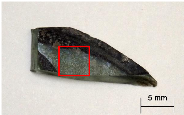
Probe HKV 2, Glasbruchstück mit schwarzer Emailfarbenmalerei und darüberliegender weißer Emailfarbe, Untersuchungsbereich der weißen Emailfarbe (rot markiert), Innenseite
