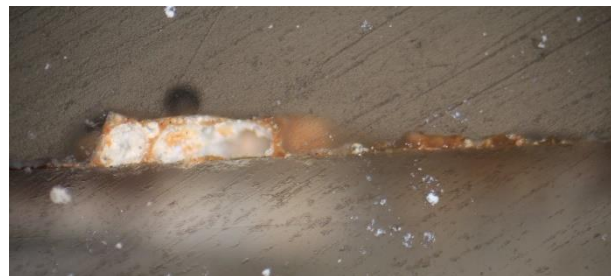
Probe HKV 21, Querschliff mit brauner und schwarzer Emailfarbe auf dem Glas (unten), Fensterinnenseite, PLM
