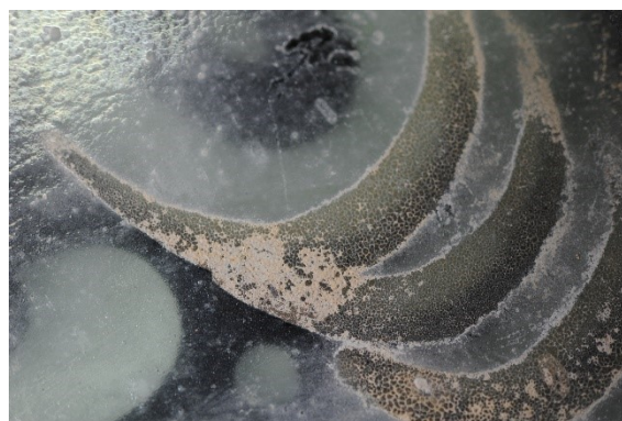
Abb. 121: Verluste der braunen Emailfarbe, Außenseite, Auflicht
