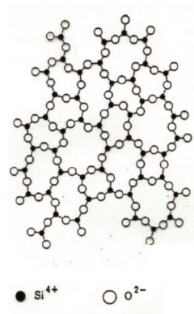
Abb. 55: Struktur des glasartigen Zustands, ungeordnetes Netzwerk
