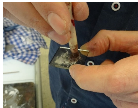
Abb. 144: Aufbringen der weißen Emailfarbe mit einem Marderhaarpinsel
