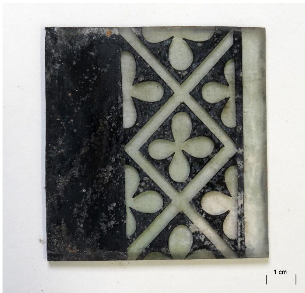
Probe HKV 7, Glasstück mit schwarzer Emailfarbenmalerei, Innenseite
