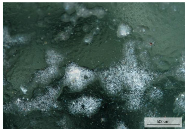
Weißer Emailfarbe unregelmäßiger Auftrag, Auflicht, HKV 6, Innenseite, SM-Aufnahme
