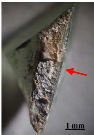
Probe HKV 21 vor dem Einbetten, Oberfläche mit weißer und darunterliegender brauner und schwarzer Emailfarbe, Innenseite, in Pfeilrichtung angeschliffen
