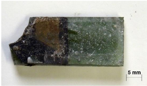
Probe HKV 6, Glasbruchstück mit schwarzer und brauner Emailfarbenmalerei und darüberliegender weißen Emailfarbe, Innenseite, Bleifeld 1d
