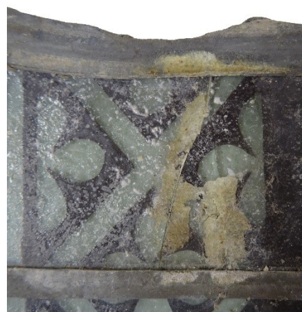
Abb. 107: Klebung eines Glases, vermutlich zwischen 1990-93, Bleifeld 1d, Innenansicht
