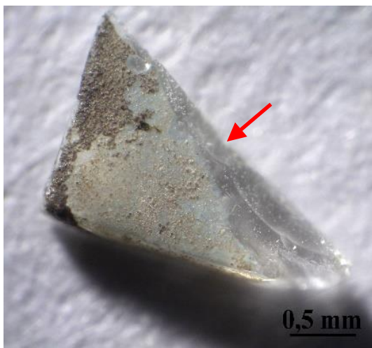
Probe HKV 19 vor dem Einbetten; weiße Emailfarbe auf Glas der Fensteraußenseite
