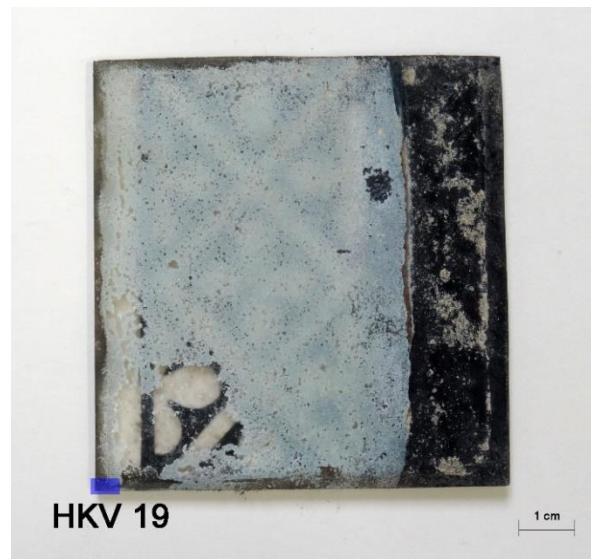
Probe HKV 19 mit weißer Emailfarbe (Außenseite)
