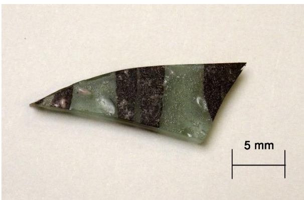
Probe HKV 3, mit schwarzer Emailfarbenmalerei und darüberliegender weißen Emailfarbe, Innenseite, Bleifeld 1d
