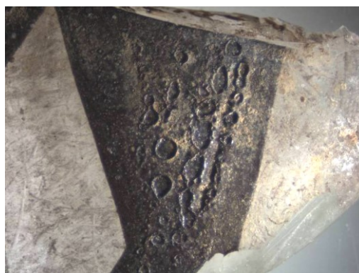
Abb. 67: schwarze Emailfarbe mit Kratern, Detail aus Bleifeld 1d
