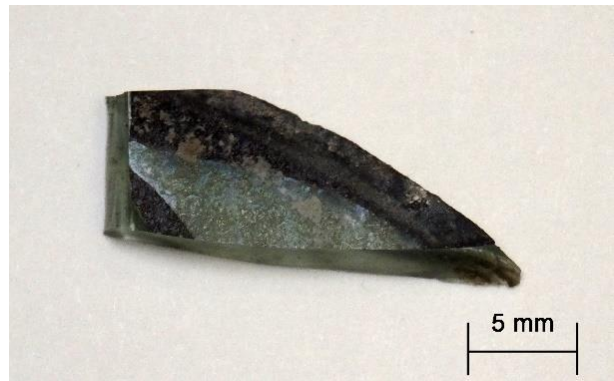
Probe HKV 2, Glasbruchstück mit schwarzer Emailfarbenmalerei und darüberliegender weißen Emailfarbe, Innenseite, Bleifeld 1d
