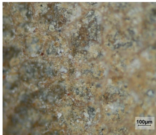
Braune Emailfarbe mit weißlichen Kristallen, vermutlich Bleikarbonat bzw. -sulfat, HKV 6, Innenseite, SM-Aufnahme
