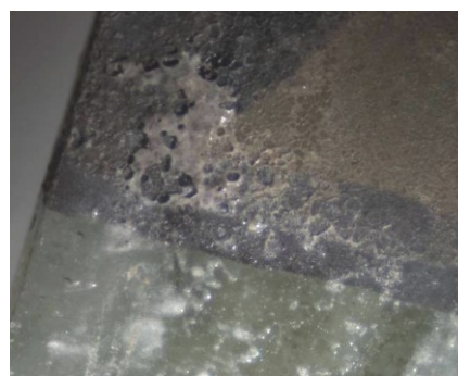
Abb. 123: Fragmentarisch erhaltene weiße Emailfarbe über der braunen Emailfarbe, Innenseite
