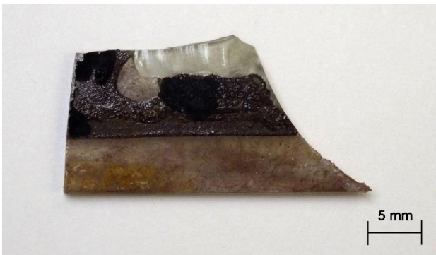
Probe HKV 4, Glasbruchstück mit brauner Emailfarbenmalerei, Innenseite
