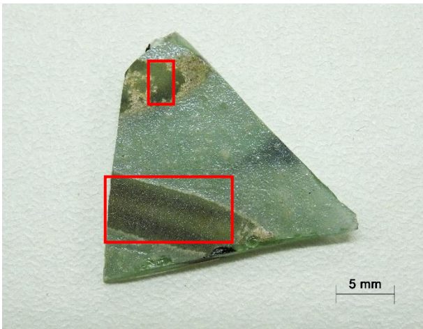
Probe HKV 1, Glasbruchstück mit brauner Emailfarbenmalerei und darüberliegender weißen Emailfarben, teilweise mit Verlusten (rot markiert), Außenseite, Bleifeld 1d
