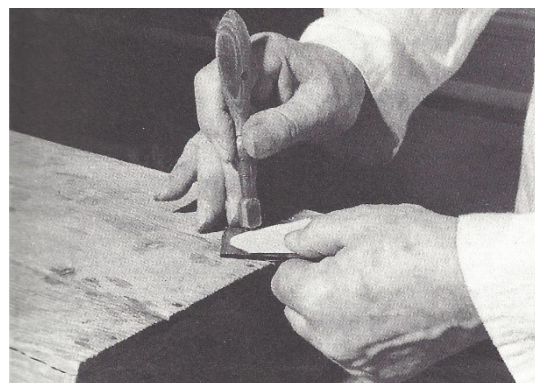
Abb. 60: Zuschneiden eines Glases mit Glasschneider und Schablone
