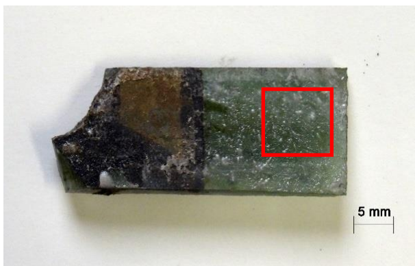
Probe HKV 6, Glasbruchstück mit schwarzer und brauner Emailfarbenmalerei und darüberliegender weißer Emailfarbe, Untersuchungsbereich der weißen Emailfarbe (rot markiert), Innenseite
