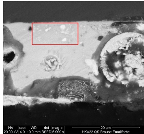
Abb. 70: Querschliff der braunen Emailfarbe mit Uranpartikel (rot markiert), Innenseite, BSE-Aufnahme
