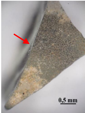
Probe HKV 16 vor dem Einbetten, Oberfläche der Fensteraußenseite mit weißer und darunterliegender brauner Emailfarbe, in Pfeilrichtung angeschliffen
