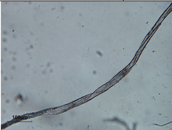
Faser, Durchlicht, linear polarisiertes Licht, Polarisatoren II
