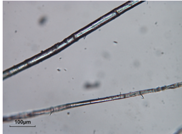
Abb. 165: Mikroskopierte Leinenfasern des Konturfadens aus Klöppelspitze von Inv. Nr. 1143 in linear polarisiertem Durchlicht (Polarisatoren ||)
