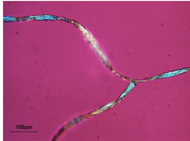
Abb. 163: Mikroskopierte Baumwollfasern von Inv. Nr. 1143 in linear polarisiertem Durchlicht (Polarisatoren X und Lambdaplättchen eingeschaltet)
