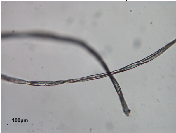
Faser, Durchlicht, linear polarisiertes Licht, Polarisatoren II
