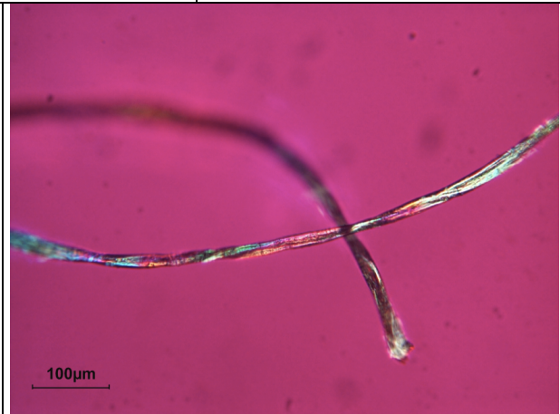
Faser, Durchlicht, linear polarisiertes Licht, Polarisatoren X, Lambdaplättchen eingeschaltet
