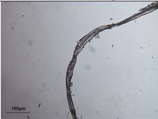
Faser, Durchlicht, linear polarisiertes Licht, Polarisatoren II
