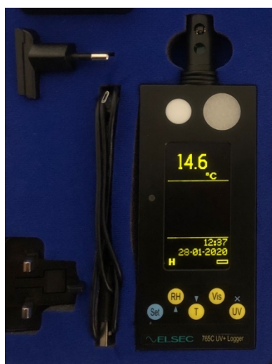
Abb. 339: Messgerät für Klima und Licht
