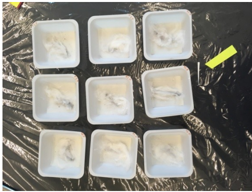
Abb. 79 Entsalzung mittels Kompressen von Grasproben
