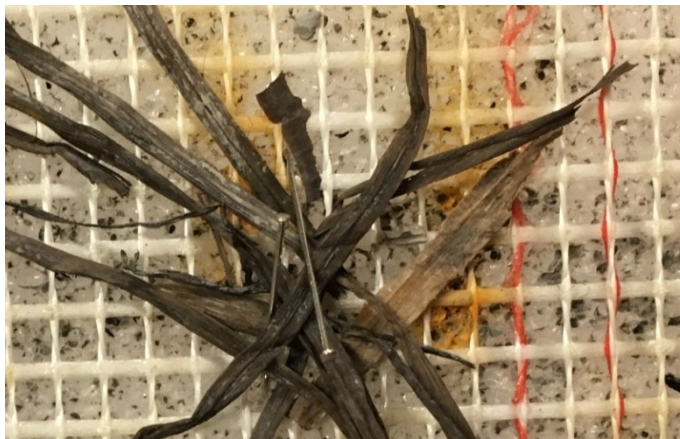
Abb. 51 Verfärbungen durch Korrosion von Stecknadeln (Inv.Nr. 114.549)
