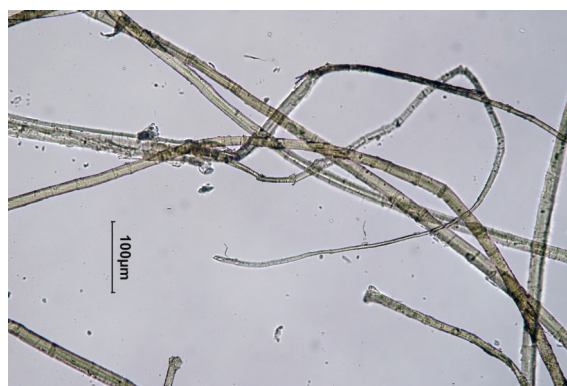
Abb. 135: Mikroskopaufnahme F_B_11, Nähfaden aus Leinen , 20-fache Vergrößerung
