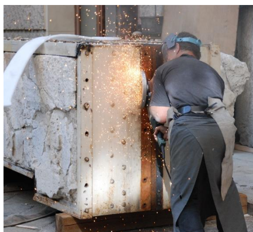
Abb. 24: Auftrennen mit dem Winkelschleifer
