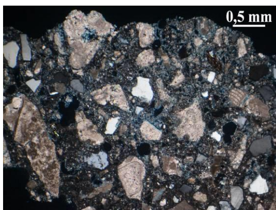
Abb. 39: SHT-P1, Dünnschliff im Durchlicht, gekreuzte Polarisatoren; vorwiegend karbonatischer, kantiger Zuschlag
