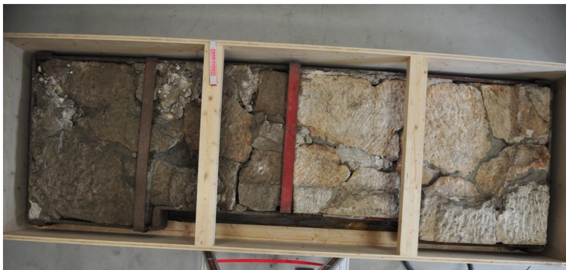
Abb. 83: Aufnahme während der Trockenreinigung. Linke Hälfte: ungereinigt, rechte Hälfte: gereinigt.
