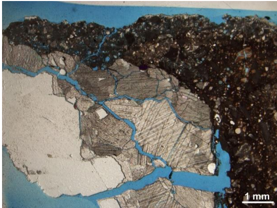
Abb. 47: Sterzinger Marmor mit Ergänzungsmasse, polierter Dünnschliff.
