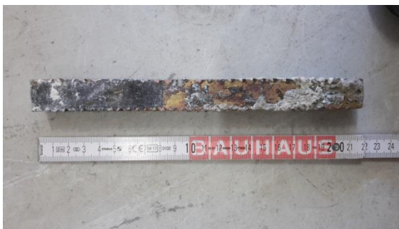
Abb. 92: Vollständig freigelegter Messingzapfen.
