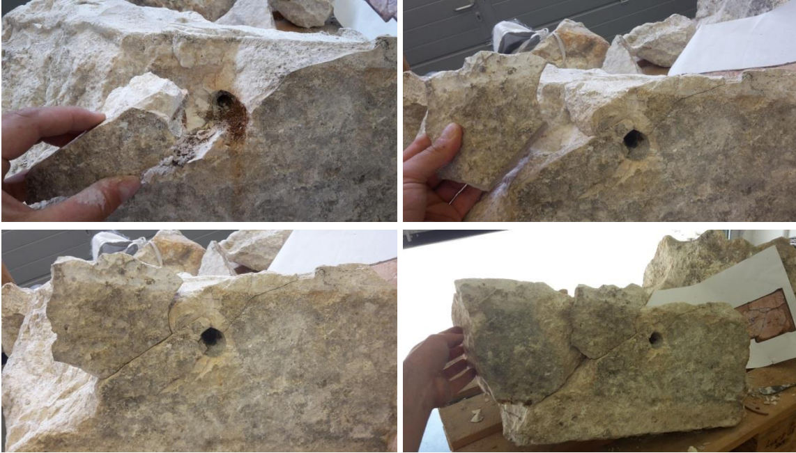
Abb. 98-101: Abfolge von kleineren Bruchstücken, welche nach und nach verklebt werden.
