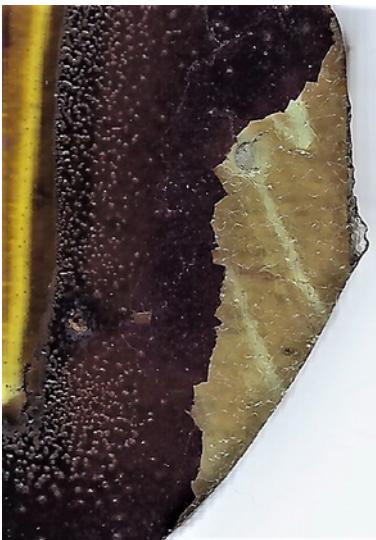
Abb. 84: Bereich mit verlorenem violettem Email im Bereich eines Glasbruches von GS 5
