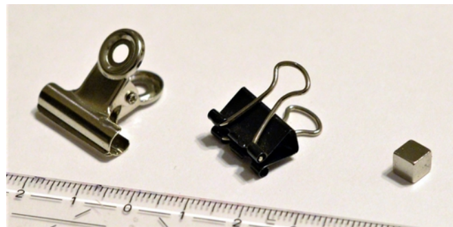
Abb. 96: Hilfsmittel zur Einrichtung und Fixierung der Bruchstücke: Maulklemmen und Neodymmagnet
