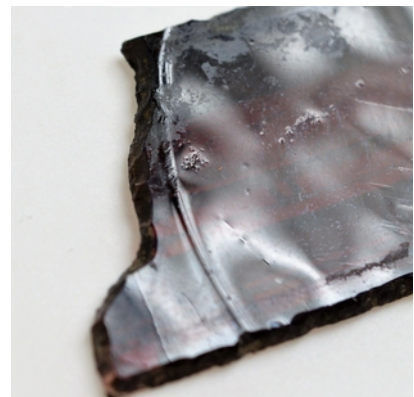
Abb. 41: Oberflächeninhomogenität, s.g. "Rampe"
