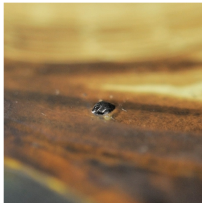
Abb. 40: Einschluss in der Glasoberfläche
