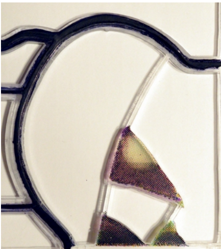
Abb. 123: Detail des bedruckten Rahmens mit Verbindungsbrücken und schwarzem Abstandhalter
