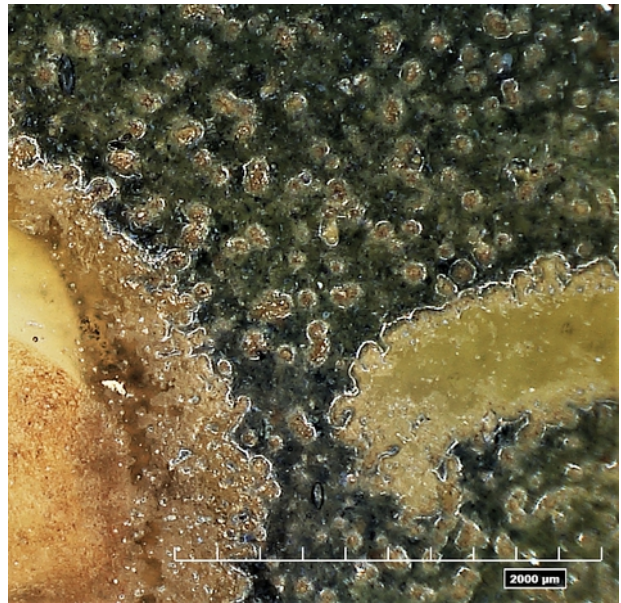
Abb. 49: blaues Email, partiell ausgekratzt; offene Gasblasen; Rückseite GS 10
