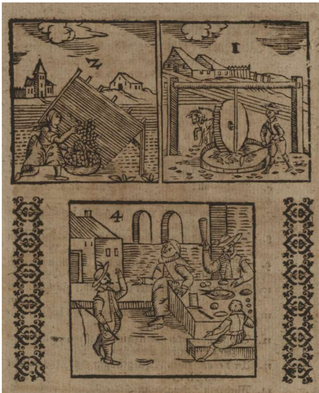
Abbildung 6: Die Darstellung zeigt drei Arbeitsschritte in der Waidproduktion (von oben links beginnend): die Waidernte, die Waidmühle und das Formen der Waidbälle, um 1631 (Quelle: Internet)
