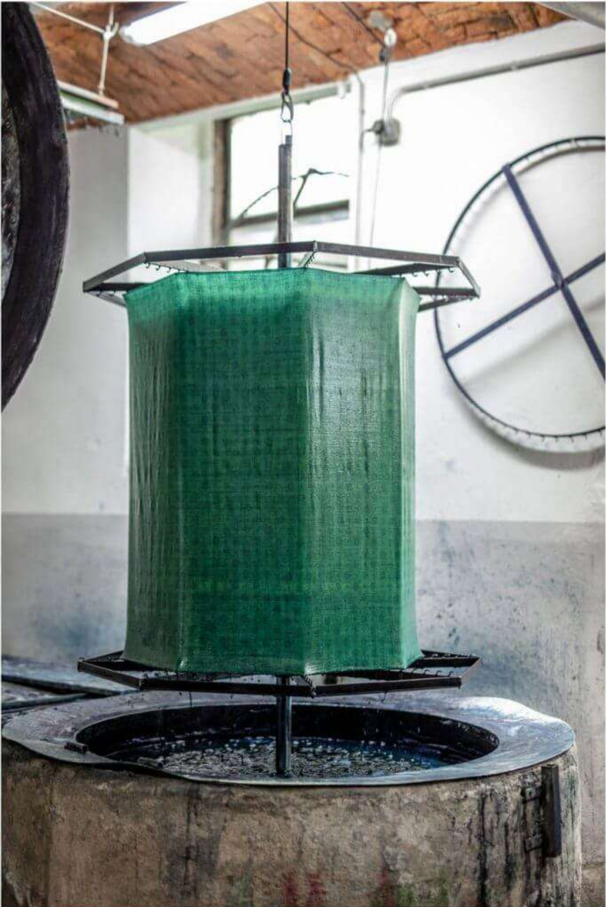
Abbildung 17: nach dem ersten Zug in der Indigoküpe. Der Prozess des Erblauens am Textil (Quelle: Internet)
