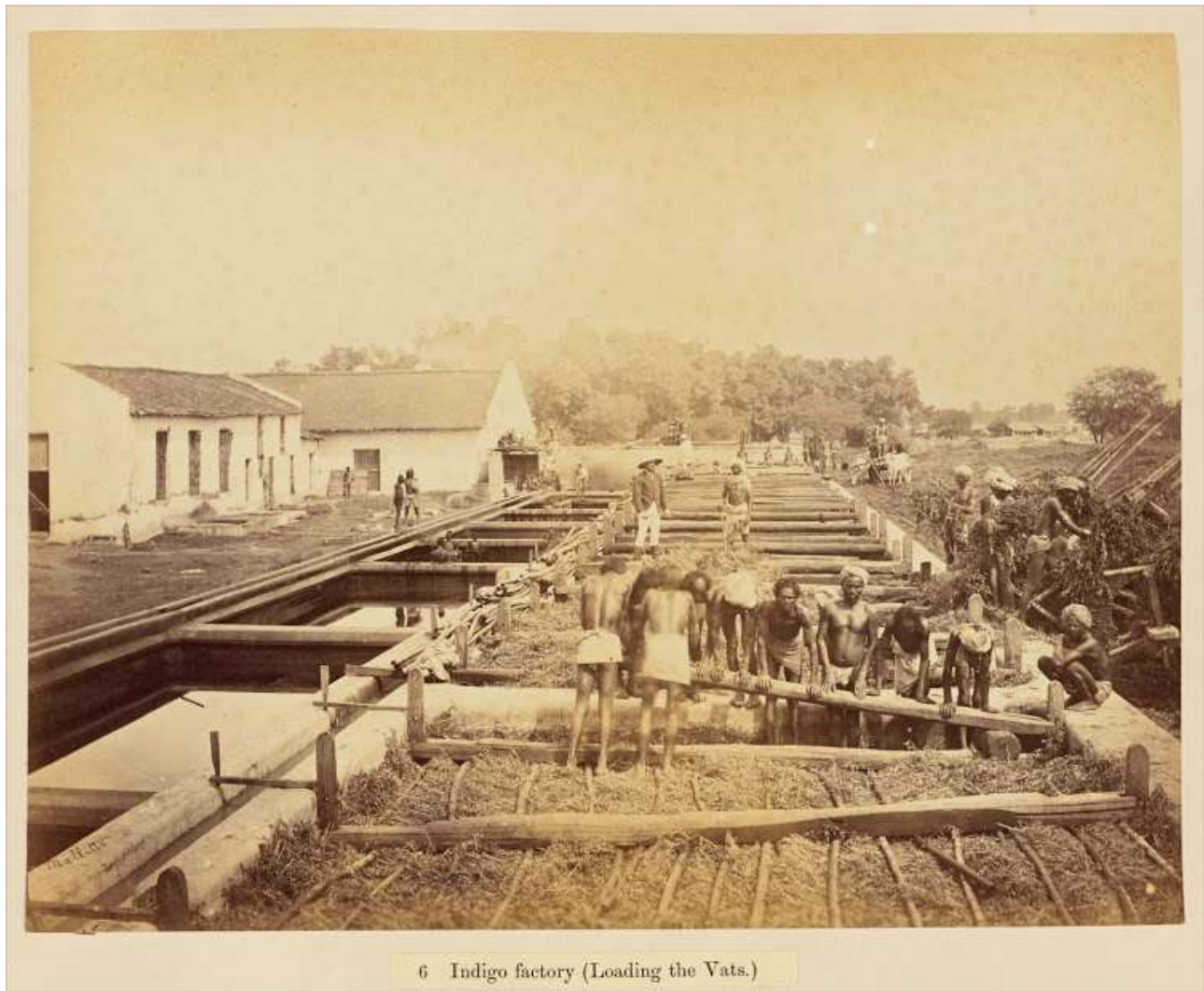
Abbildung 7: Eine Szene in einer Indigoterie: Arbeiter beim Befüllen der Indigoküpen, 19. Jahrhundert (Quelle: Internet)
