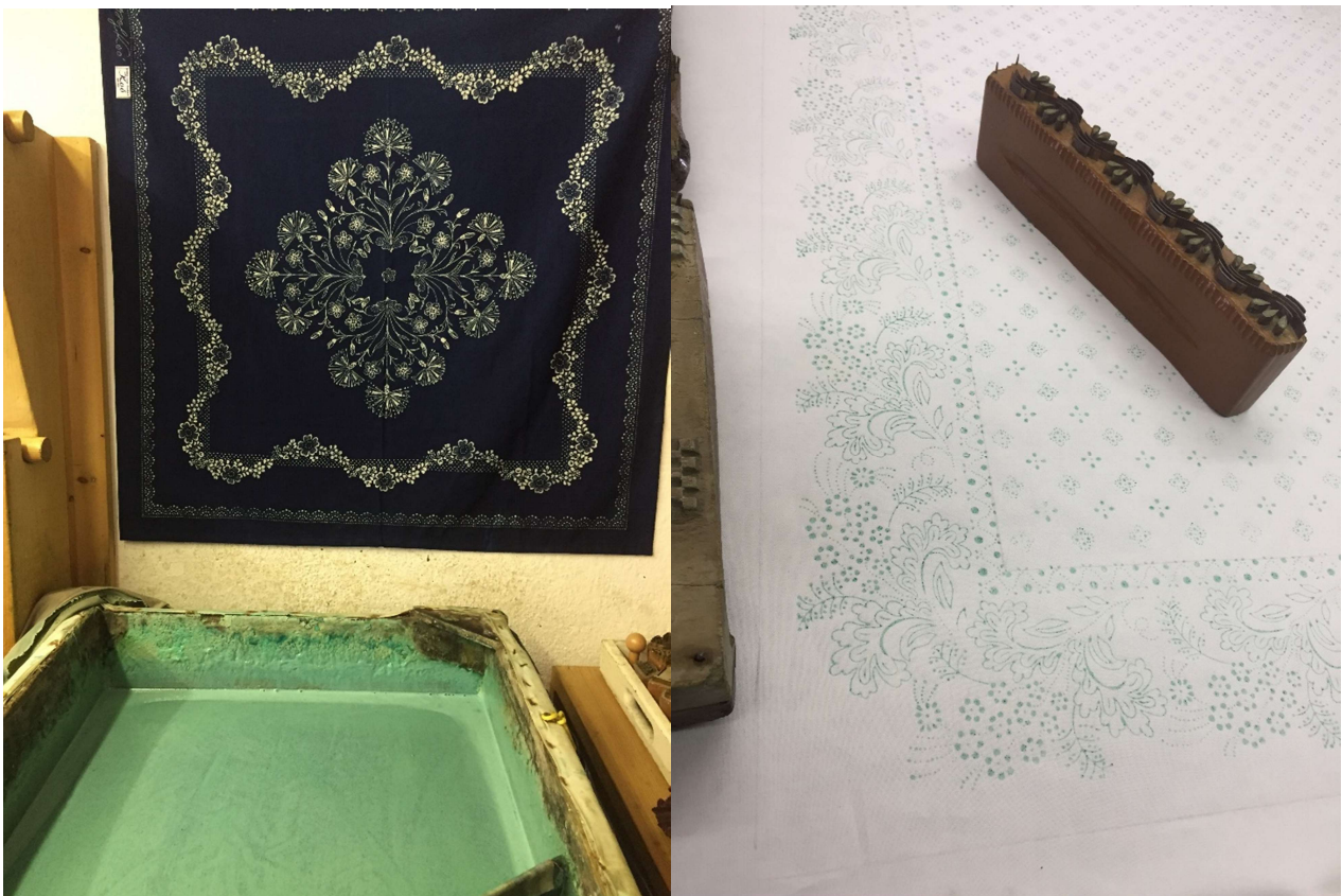
Abbildung 12+13a: links: der fertige Papp; rechts: der bereits aufgedruckte Papp mit einer Model (Quelle: Autorin)
