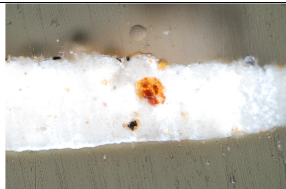
Querschliff, Auflicht, fotografiert bei Vergrößerung 200x. Bei der dunklen Verfärbung handelt es sich um Eisenkorrosion.
