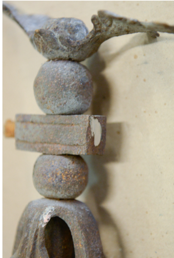
Abb. 154, die Reste des Flachnietes wurden bis auf die Nullfläche abgefeilt.
