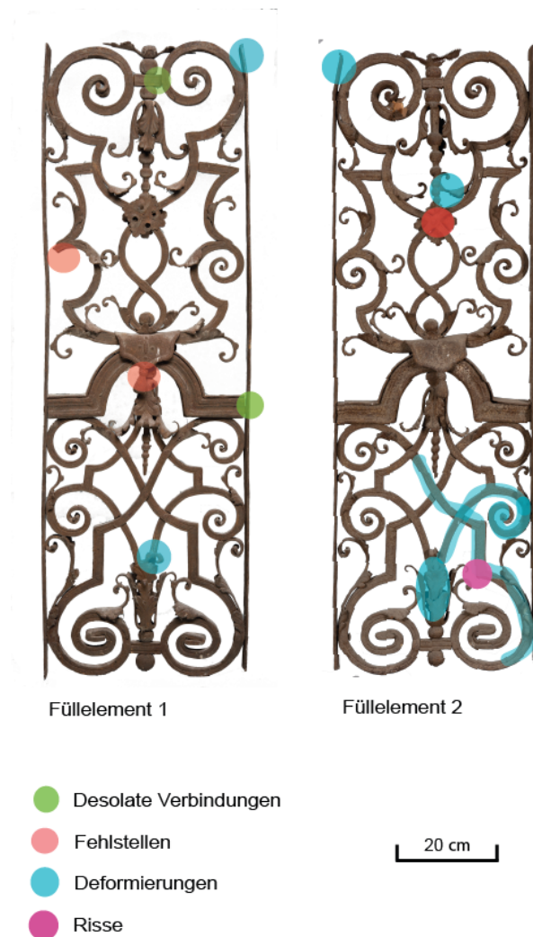
Abb. 119, Schadenskartierung der Füllelemente.
