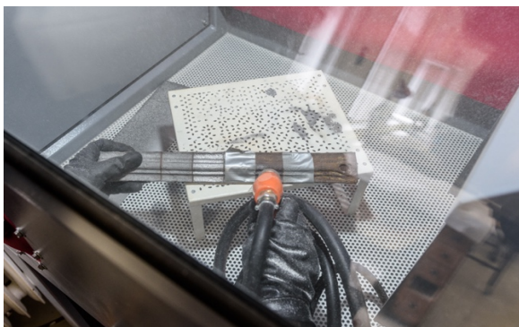
Abb. 146, Strahlkammer während des Strahlvorgangs.
