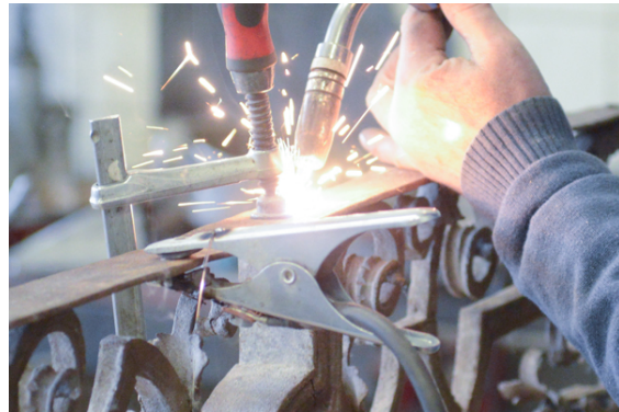
Abb. 162, Aufschweißen von Material.
