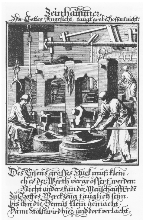
Abb. 41, wasserkraftbetriebener Zainhammer. Ende 17. Jhdt.
