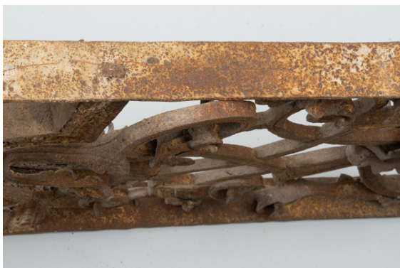
Abb. 120, Füllelement 2, verbogenes Gestänge, die Volute ragt heraus.
