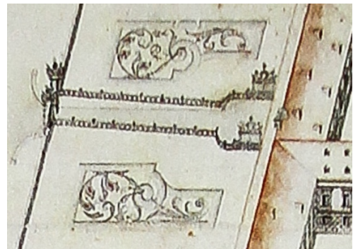
Abb. 30, Detail von Abb. 29. In diesem Plan ist eine schmiedeeiserne Einfriedung schematisch eingezeichnet.
