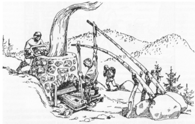
Abb. 37, mittelalterlicher Rennofen, mit menschlicher Kraft betriebene Blasebälgen.
