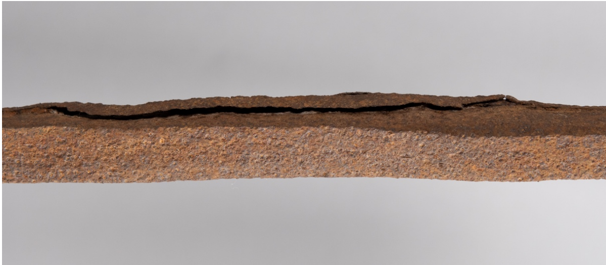
Abb. 39, beim Ausschmieden entstandene Abspaltung dünner Schichten aufgrund von Schlackeneinschlüssen.
