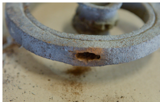
Abb. 152, Detail, Loch nach dem Herausziehen des Flachniet.
