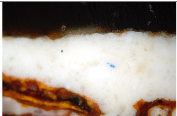
Querschliff, Auflicht, fotografiert bei Vergrößerung 200x. Der blaue Punkt deutet auf ein Pigment aus künstlichen Ultramarin hin.
