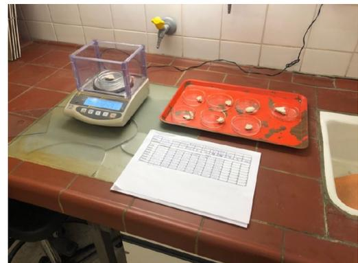
Abb.172: tägliche Gewichtsmessung im Labor nach Steigerung der relativen Luftfeuchte, 2021
