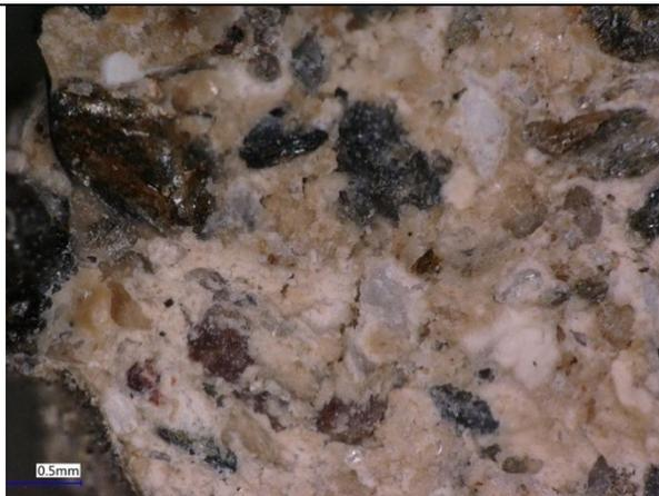
Quebruch im Digitalmikroskop, Putzgefüge, Auflicht,
