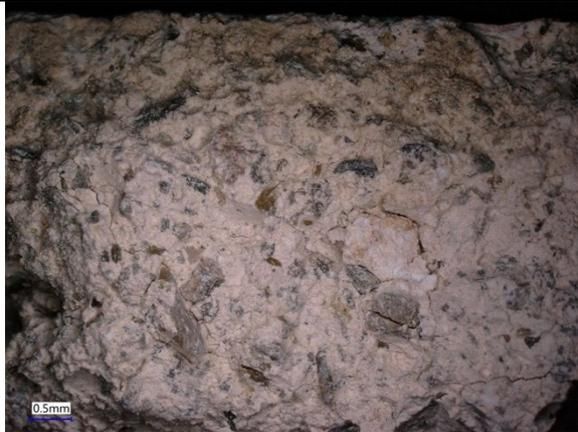
Querbruch im Digitalmikroskop, Putzgefüge, Auflicht,
