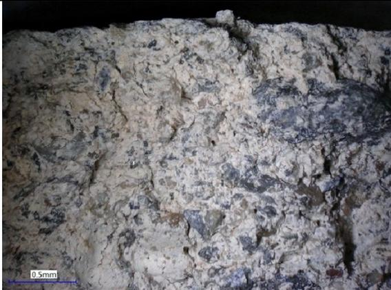
Querbruch im Digitalmikroskop, Putzgefüge, Auflicht,
