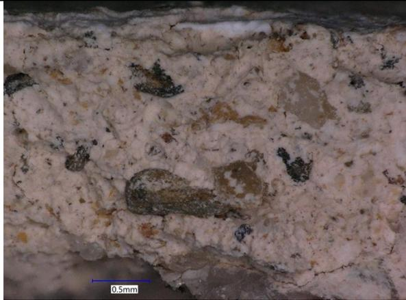
Quebruch im Digitalmikroskop, Putzgefüge, Auflicht,
