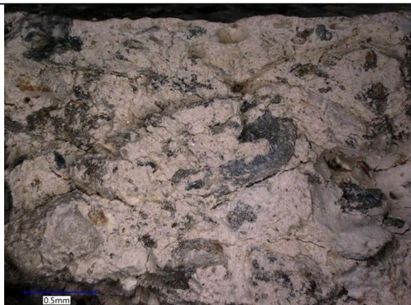
Querbruch im Digitalmikroskop, Putzgefüge, Auflicht,
