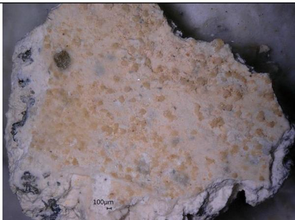
Quebruch im Digitalmikroskop, Putzgefüge, Auflicht, 100x
