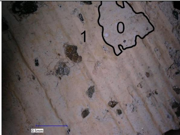
Probenoberfläche im Digitalmikroskop, Oberfläche, Putz (0), Tünchereste (1), Auflicht,
