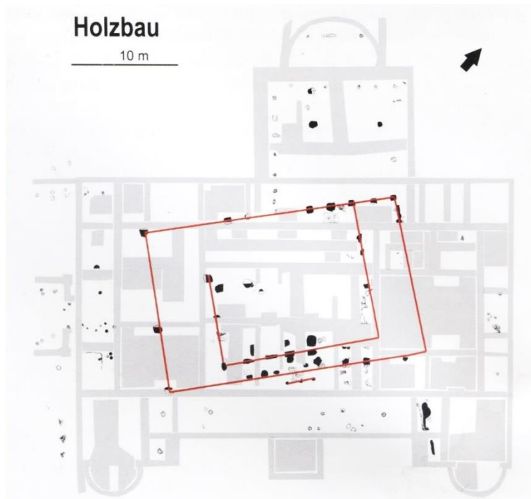
Abb. 5: Plan mit Markierung der Holzbauphase, rot markiert ist der vermutete rechteckige Grundriss; schwarze Markierungen geben Gräbchen und Pfostenlöcher an; grau wiedergegeben sind die späteren Überbauungen.
