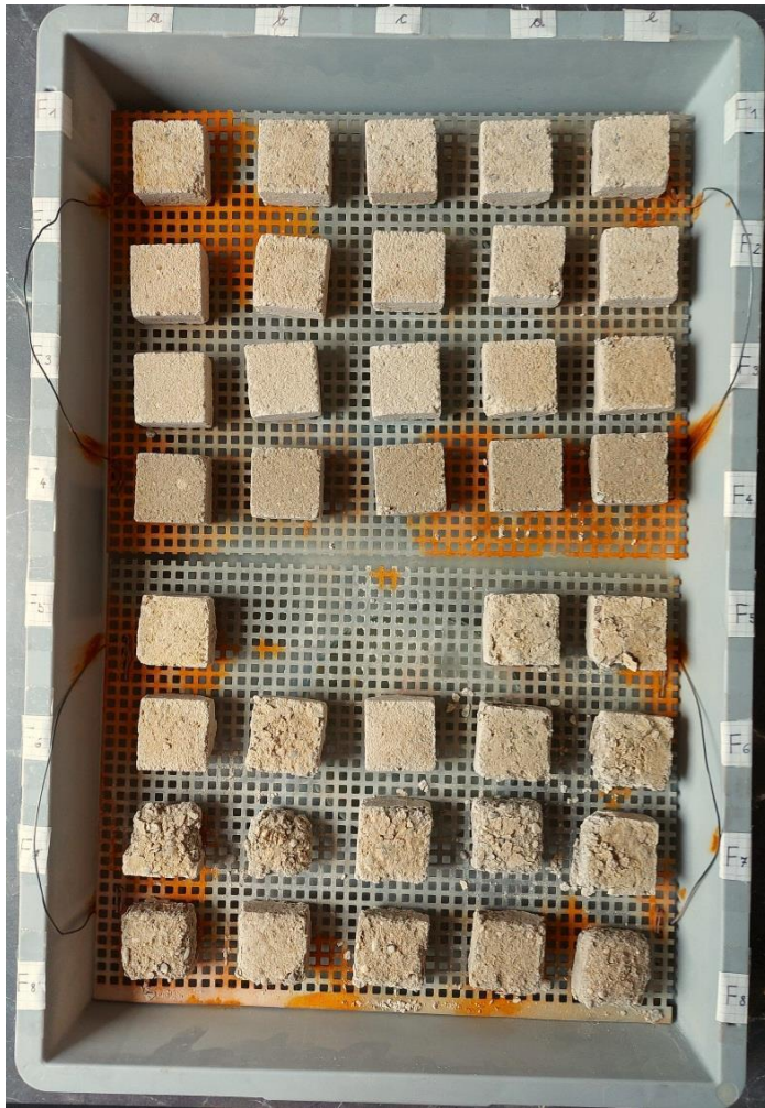
Abb. 123: Mörtel-Testkörper nach dem 16. Zyklus.
