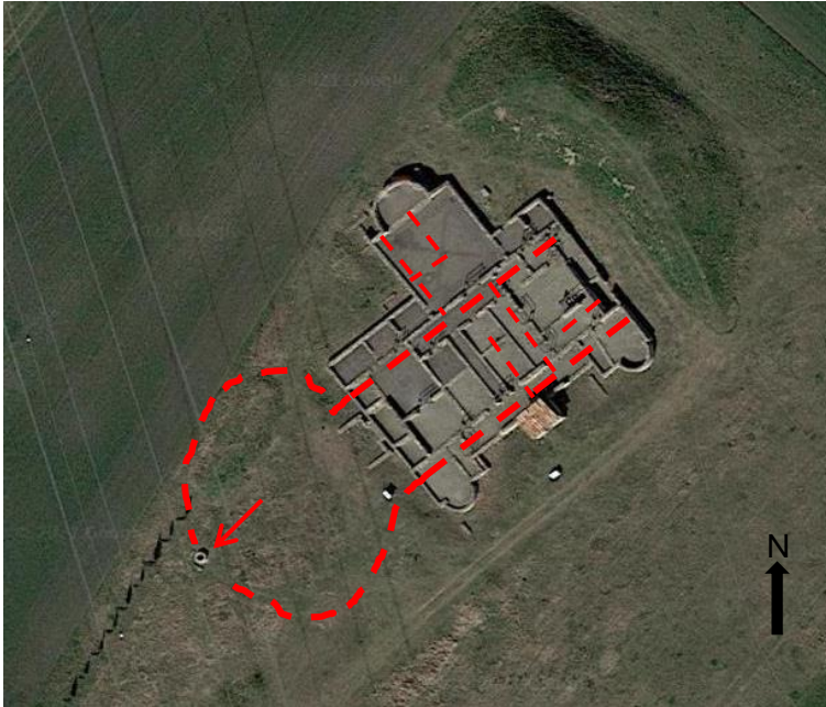
Abb. 60: Verlauf der Drainagegräben, der rote Pfeil markiert den rekonstruierten Brunnenschacht über den Sickerschacht.
