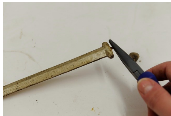
Abb. 212 Entfernung von rostigen Eisenstiften.
