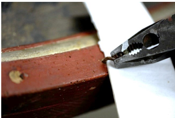
Abb. 211 Entfernung von rostigen Eisenstiften.
