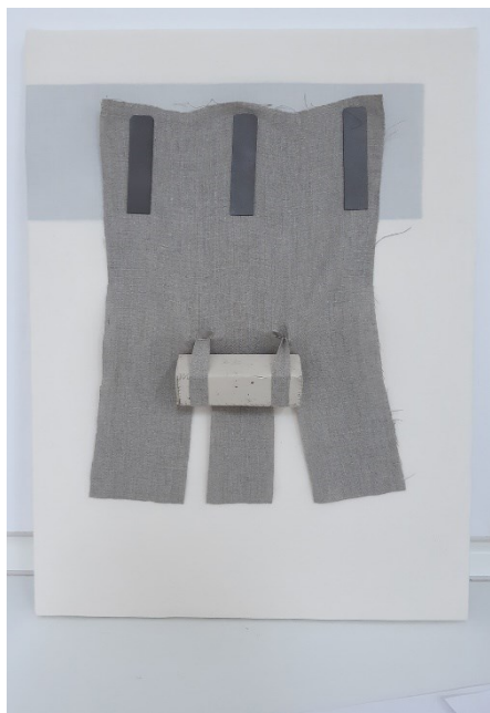
Abb. 190: Belastungstest mit einem Gewicht auf dem Modell der Montageplatte mit Eisenplatte und Magnetstreifen
