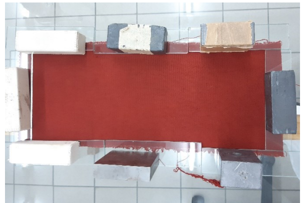
Abb. 209: Ausgelegtes und mit Glasplatten und Gewichten beschwertes Gewebe
