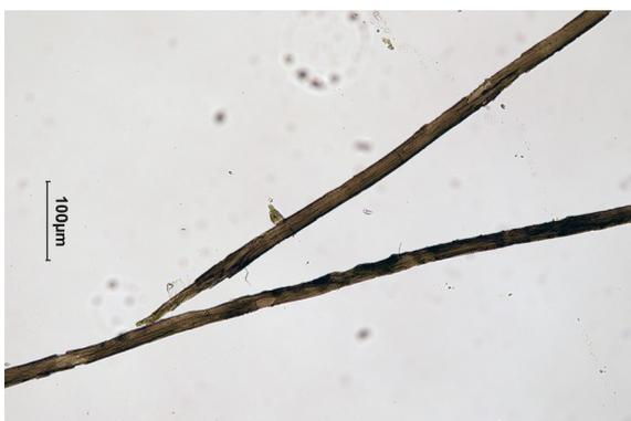
Abb. 132 : Mikroskopaufnahme F\_B\_3, Seide Oberstoff Haubenbasis, 20-fache Vergrößerung
