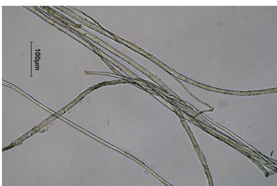
Abb. 134: Mikroskopaufnahme F\_B\_1, Leinen Futter, 20-fache Vergrößerung
