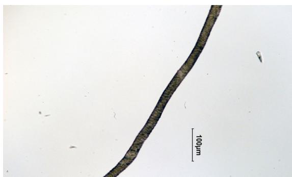
Abb. 124: Mikroskopaufnahme F\_A\_6, Wolle, Haubenbasis Schneppe, 20-fache Vergrößerung
