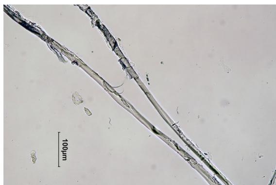
Abb. 133: Mikroskopaufnahme F\_B\_5, Seide von der Gaze, 20-fache Vergrößerung
