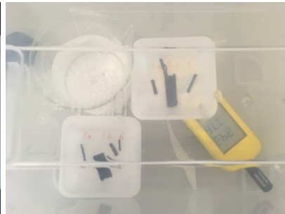
Abb. 85 Kontrolliertes Trocknen mit Salzlösung
