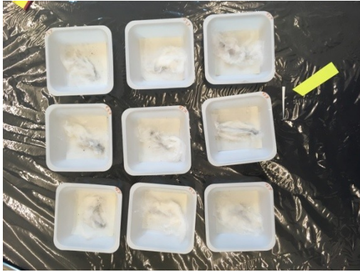
Abb. 79 Entsalzung mittels Kompressen von Grasproben
