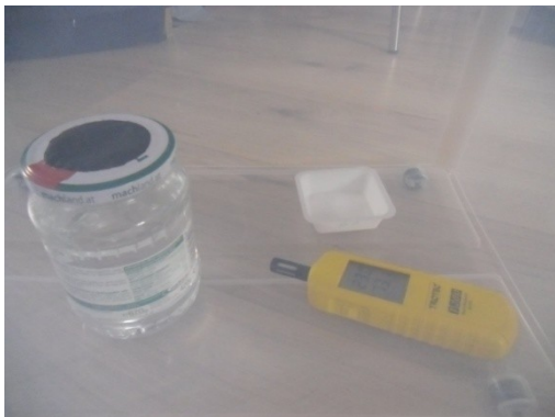
Abb. 66 rF mittels übersättigter NaCl-Lösung in Einmachglas mit Gore-Text Membran im Deckel, auf 75% eingestellt
