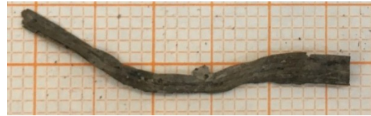
Abb. 81 Probe III2c zeigt nach der Entsalzung eine Deformierung auf
