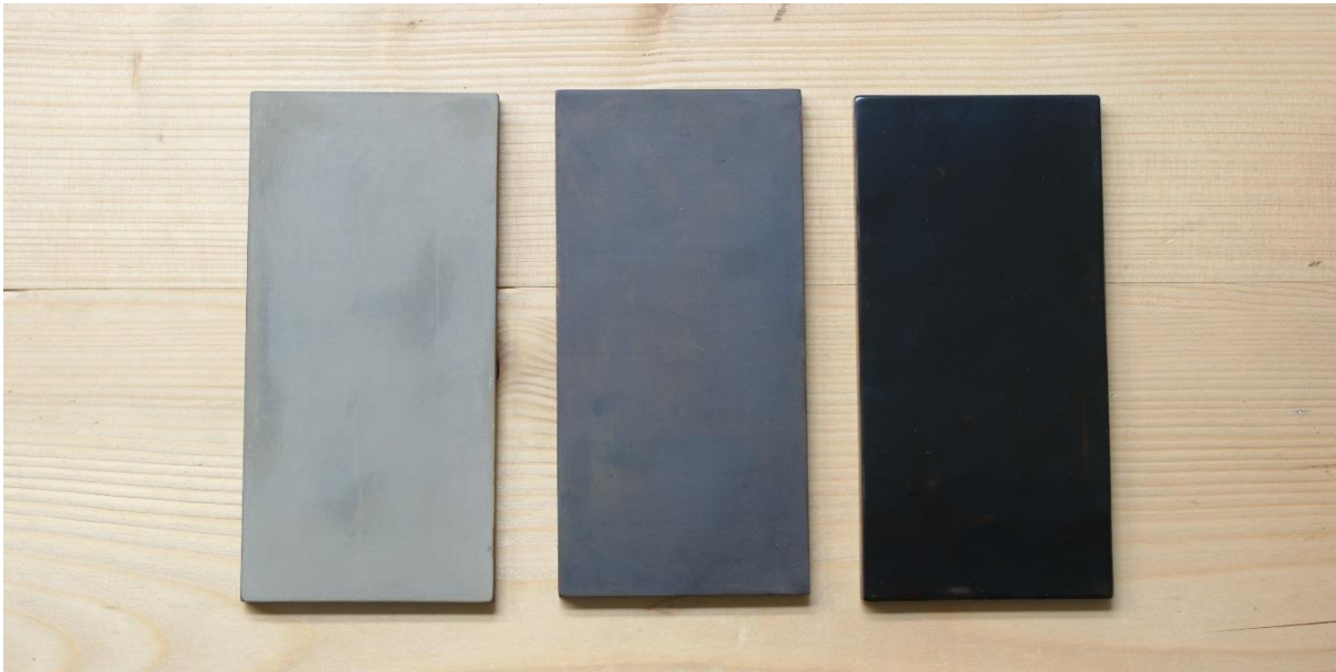
Abb. 88: Probekörper mit Grundierung, Grundierung mit Sabi-Gatame, und Lackschichten.
