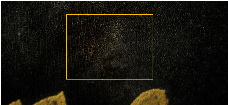
Abb. 82: Ausbleichung der Lackschicht, Mikroskopaufnahme, MD 040586.
