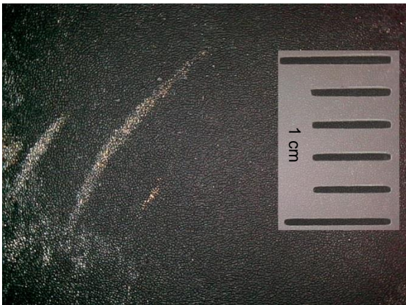
Abb. 71: 200-fache Vergrößerung eines Kratzers auf MD 040580.
