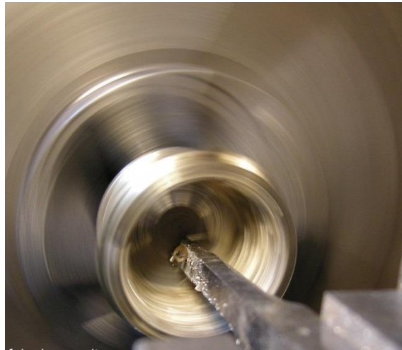
Abb. 109: Bearbeiten der Ausgussstelle mit einem Steckmeißel.
