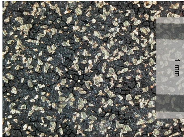
Abb. 56: Mikrorissstruktur der Lackoberfläche mit aufliegenden Goldpartikel, MD 040580.
