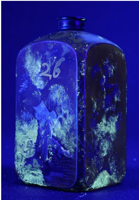
Abb. 101: UV-Aufnahme vor der Entfernung der Klebstoffrückstände, MD 040587.
