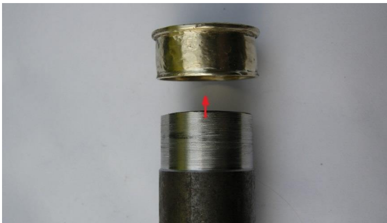
Abb.111: Dorn zur Aufweitung auf den gewünschten Durchmesser.
