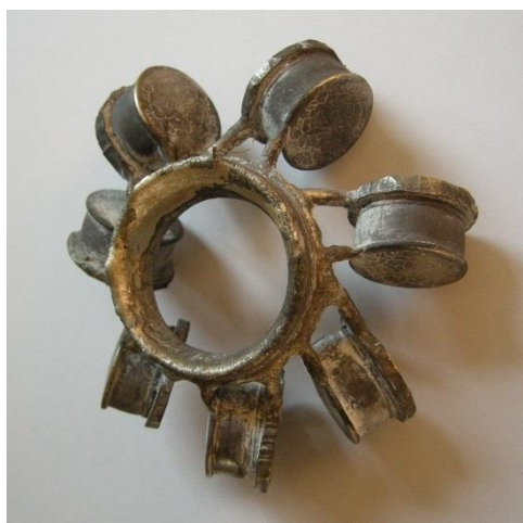
Abb. 107: Verschlüsse nach dem Schleuderguss.
