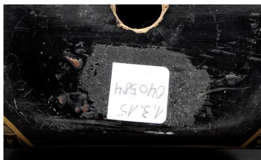
Abb. 67: Klebstoffrückstände eines entfernten roten Aufklebers, MD 040584.
