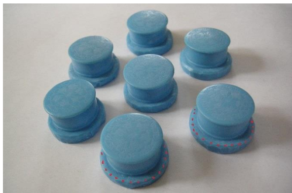
Abb. 106: Wachsmodelle mit Bearbeitungszugabe.
