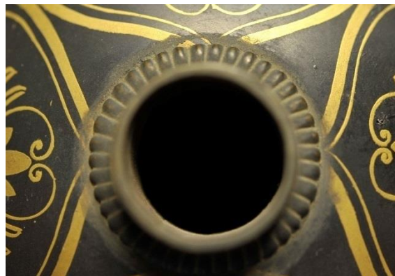
Abb. 58: Schmutzablagen und Oxidationsprodukte rund um den Ausguss, MD 040583.
