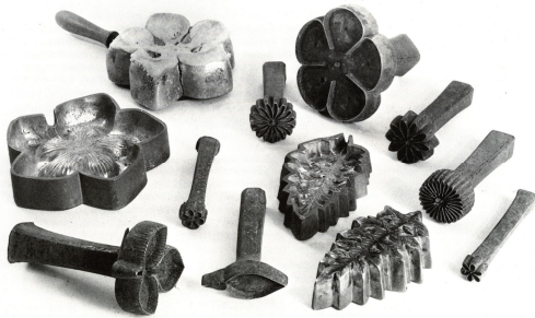
Abb. 74 Stanzen und Messingprägeformen zur Papierblumenfabrikation, um 1900
