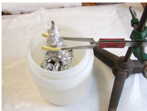
Abb. 226: Die mit Alufolie umwickelten Blüten wurden in eine Sodalösung gebracht.
