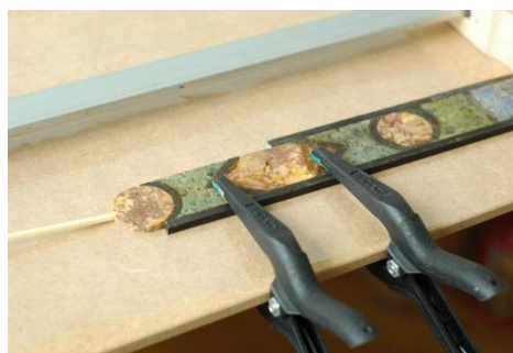
Abb. 209: Ein eingespreiztes Holzstäbchen erzeugt den nötigen Druck und Klemmen fixieren die Steinelemente am Untergrund.
