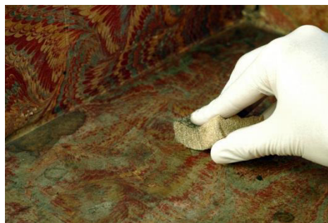
Abb. 201: Reinigung der Papieroberfläche mit Latexschwämmen „Wallmaster“.
