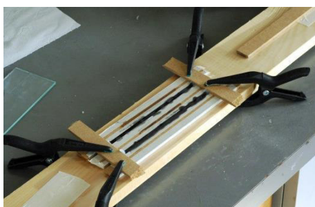
Abb. 204: Zur Ergänzung der fehlenden Pietra Dura-Elemente wurden zunächst Vierkantstäbe aus Epoxidharz gegossen.
