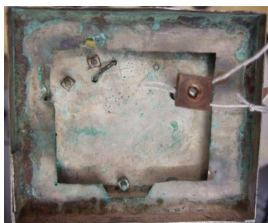
Abb. 191: Grüne Korrosionserscheinungen an einem Silber-Kupfer Lot unter einer Figur am Prunkschrank.
