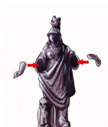
Abb. 162: Manche Elemente (hier Arme) wurden nach dem Guss an der Figur aufgelötet.
