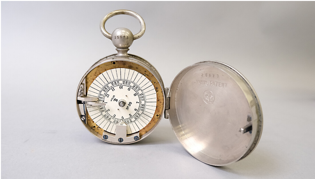
Abb. 2: Foto: Tabea Rude, tragbare Wächterkontrolluhr mit Papierscheibensystem
