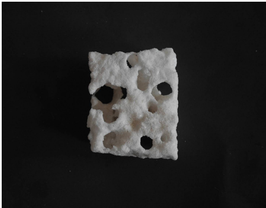
Abb. 9: Ein Stück EPS nach zwei Wochen Koexistenz mit ca. 50 Larven von Tenebrio molitor
