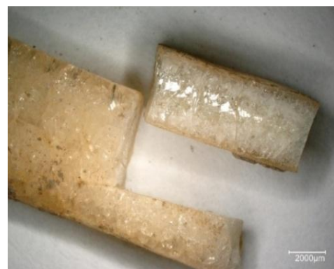
Abb. 11: Quader-Bruch an Zahnbürste, Inv.Nr. 2252, 3D-Mikroskop Aufnahme
