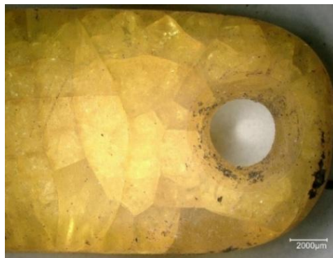
Abb. 10: Charakteristische, kubisch-musterartige Degradation an Zahnbürste, Inv.Nr. 6384, 3D-Mikroskop Aufnahme
