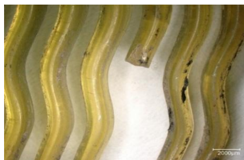
Abb.14: Bruchstelle an vergilbtem PS-Kamm, Inv.Nr. 6903, 3D-Mikroskop Aufnahme
