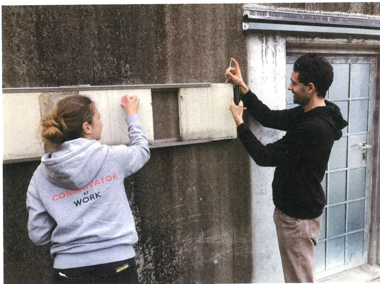
Abb. 5: Evaluierung der Freiluftbewitterungsanlage von Schlammplatten, Mauerbach, NÖ
