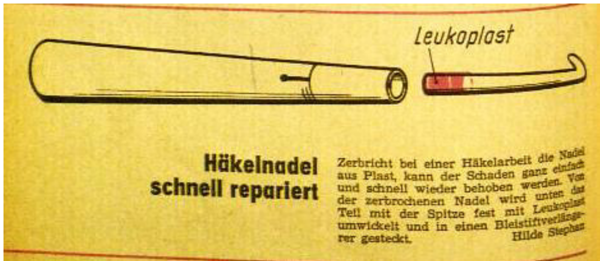
Abbildung 23 practic 6/1970, S. 282, Häkelnadel schnell repariert
