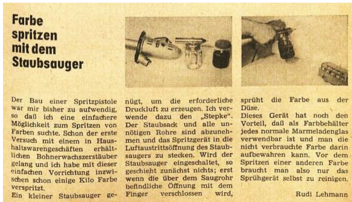
Abbildung 19 practic 2/1967 S. 89, Farbe spritzen mit dem Staubsauger
