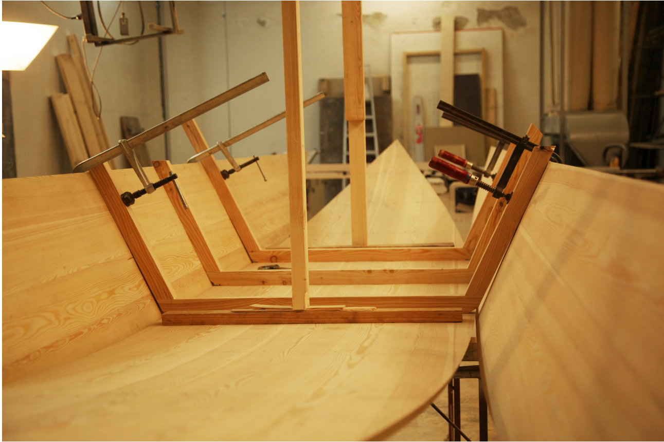
Abb.33 Biegen des Rumpfes, Sicht von innen
