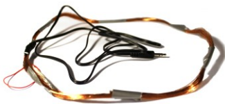
Abb. 34: 0,2mm Kupferlackdraht, ca. 180 Windungen, Ø 24cm
