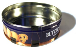
Abb. 33: 0,15mm Kupferlackdraht, ca. 200 Windungen, Ø 19,5cm
