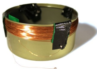
Abb. 31: 0,15mm Kupferlackdraht, ca. 400 Windungen, Ø 8,5cm
