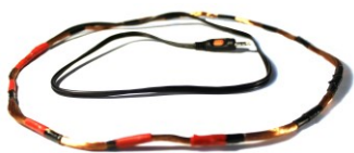
Abb. 35: 0,2mm Kupferlackdraht, ca. 175 Windungen, Ø 28cm
