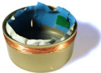
Abb. 30: 0,15mm Kupferlackdraht, ca. 200 Windungen, Ø 8,5cm
